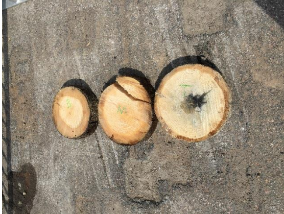
Foto 18, sågade trissor påle PG 3
