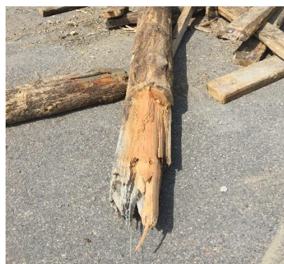
Foto 34, knäckt påle efter provdragning
