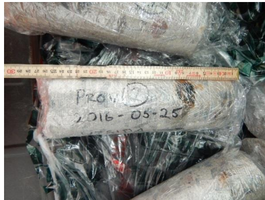
Foto 36, borrhävar betongpålar KP113
