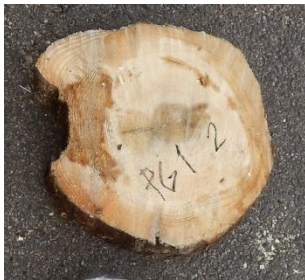
Foto 10, Sågad trissa från påle visar på rötskada och några få skeppsmaskhål
