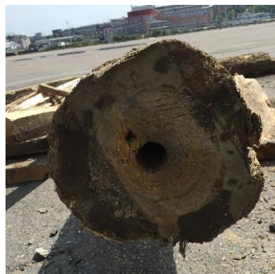
Foto 22 och 23, Okbalkar under rustbädd med träkil och påle med motsvarande hål
