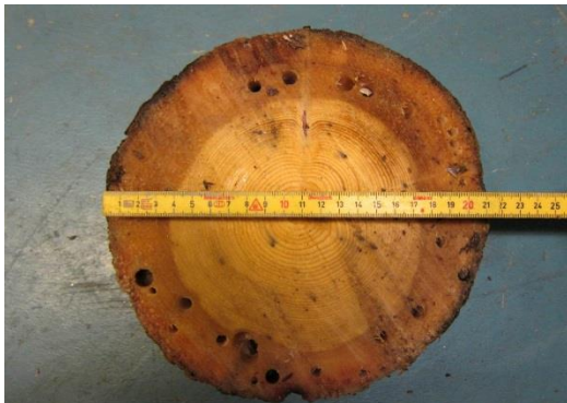
Foto 1: Provskipa kajplats 109 visar stora angrepp från skeppsmask. Notera kärnan som är oskadad.
