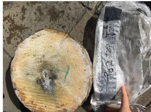
Foto 14 och 15, nerfrysta sågade trissor från påle PG2 B och PG2 T
