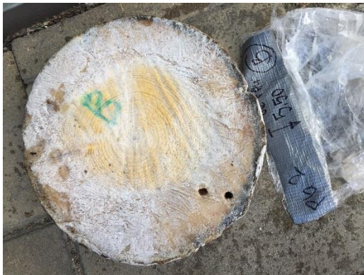
Foto 14 och 15, nerfrysta sågade trissor från påle PG2 B och PG2 T
