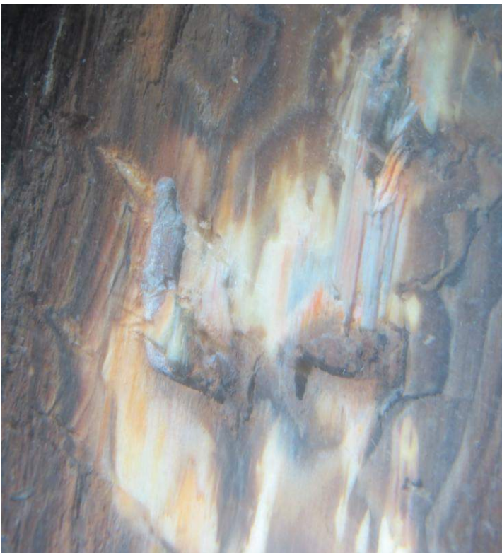
Mjuka ytskickt bortskuret med spår av skeppsmask
