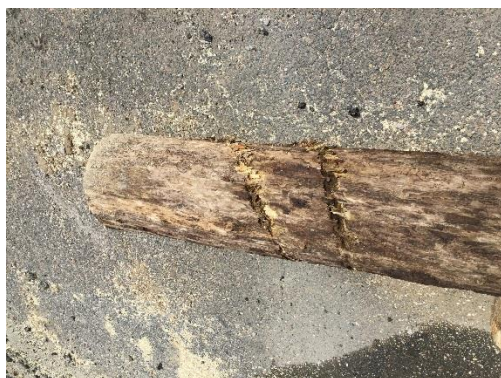
Foto 33, skador efter vajer
