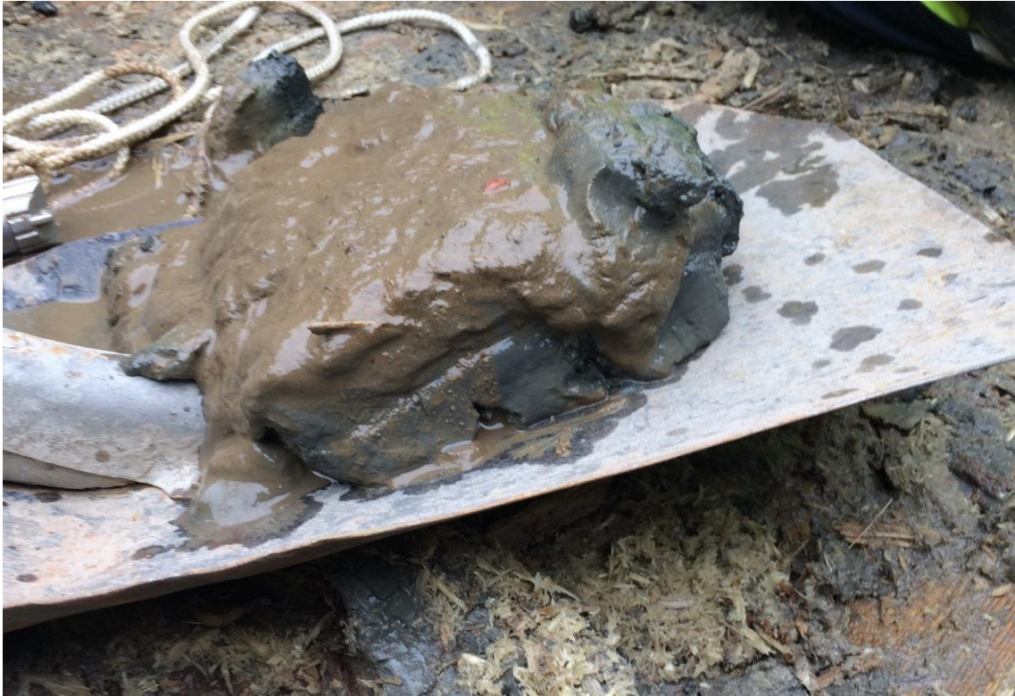
Figur 2. Provet på sedimenten från PG1602. Provet har tagits med Ekmanhuggare genom ett hål som tagits upp i rustbädden.
